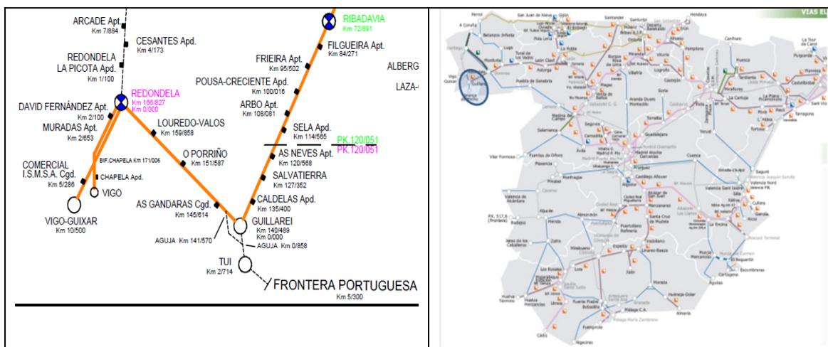
**TIPO DE TENSIÓN:** Realizar análisis de tipo de electrificación a 25 kV ca por ser frontera con Portugal pero también tener 3 kV cc en lado RFIG.
